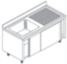
Spültisch, 1 Becken links, Abtropf- fläche rechts, mit Unterschrank und Schiebetüren Sink unit, 1 basin left, drainer right, with cupboard and sliding doors
