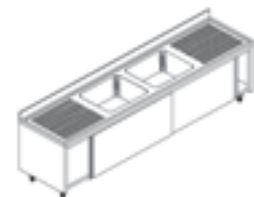
Spültisch, 2 Becken mittig, Abtropfflächen außen, mit Unterschrank und Schiebetüren Sink unit, 2 basins in the centre, drainers left + right, with cupboard and sliding doors *mit 6 Füßen/on 6 feet
