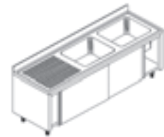
Spültisch, 2 Becken rechts, Abtropffläche links, mit Unterschrank und Schiebetüren Sink unit, 2 basins right, drainer left, with cupboard and sliding doors
