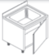
Spültisch, 1 Becken, mit Unterschrank, 1 Tür Sink unit, 1 basin, with cupboard, 1 door
