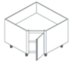
Eck-Arbeitsschrank, mit Drehtür open corner cupboard with hinged door
